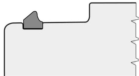
Notes : Il est important d'égaliser la tension du "gasket" (garniture d'étanchéité) à l'aide d'un tournevis en tournant celui-ci entre le "gasket et le siège en béton sur tout son périmètre (2 à 3 tours devraient suffire).
